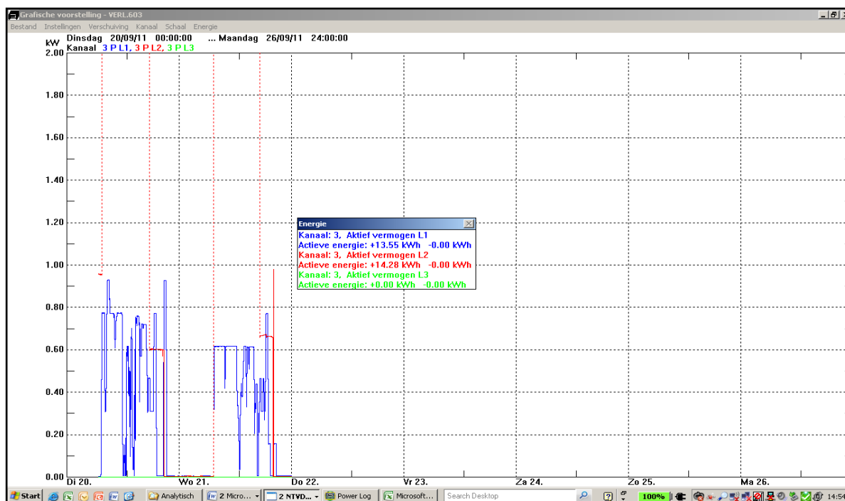
Figuur 4.32 Tijdsafhankelijke vermogen meting verlichting 0R1 en 0R2
